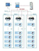
**BMS Wiring Diagram**
